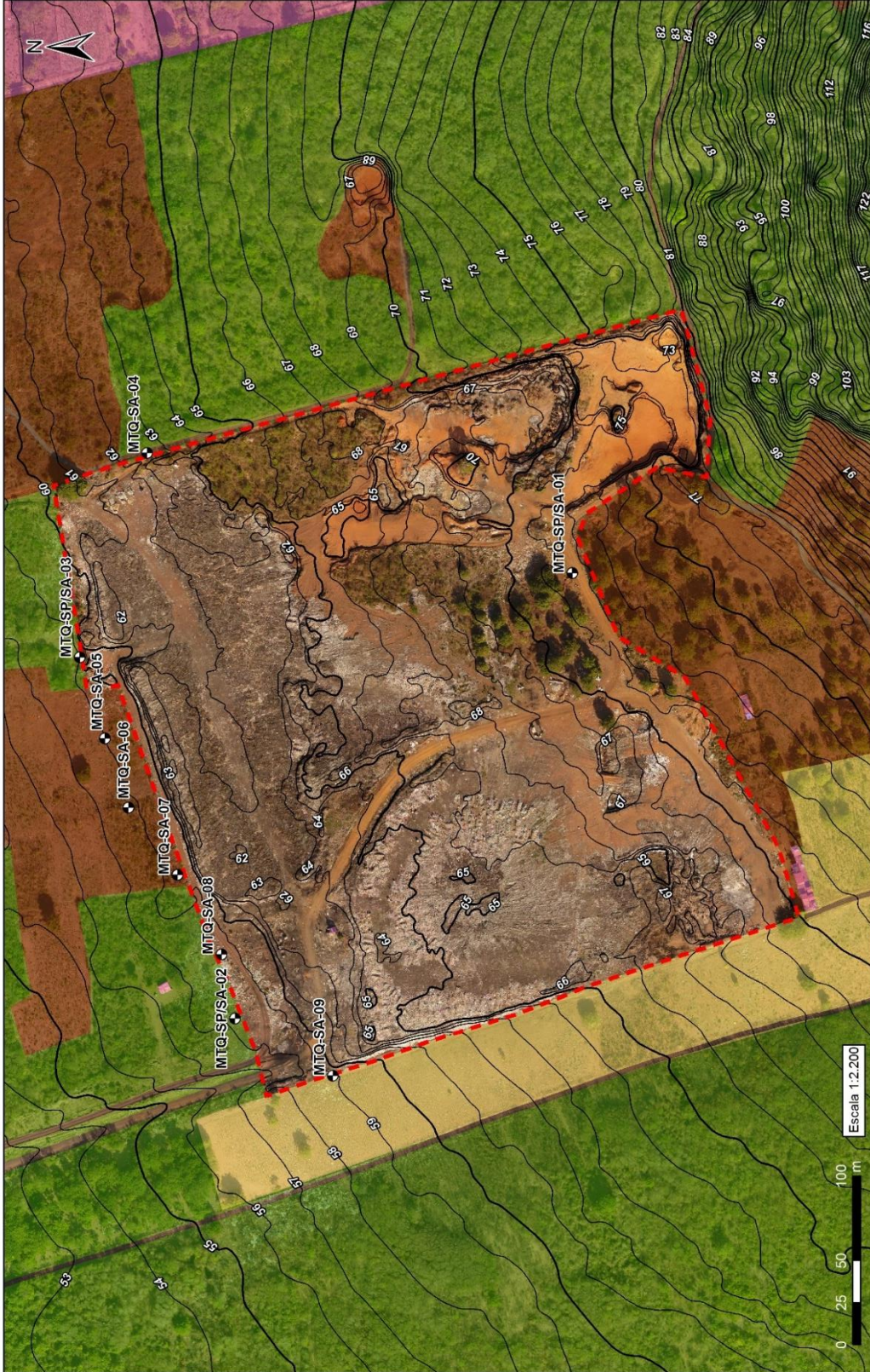
Figura 4.2 – Detalhe do levantamento planialtimétrico realizado na área do Lixão de Cascavel (Mataquiri). Fonte: TÜV SÜD Bureau, 2017-b).
